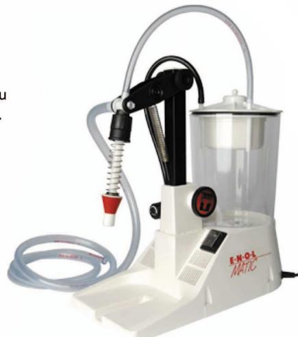
**Rýchlosť plnenia** môžete nastaviť pomocou gombíka na obrázku. Keď používate Enolmatic pre plnení fliaš olejom, paradajkovým pretlakom alebo podobne môžete pootočiť gombík na maximu. Pri plnení vína alebo piva doporučujeme pomalšie plnenie, aby sa Vám nevytvárala pena a následne nepretekala tekutina cez okraj fľaše.
